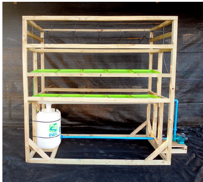
Figura 11. Vista frontal de la estructura para producción de forraje hidropónico, terminada.
