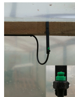
Aspersor microjet 180° para riego de forraje
