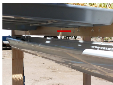
Captación de agua excedente desde las bandejas con forraje
