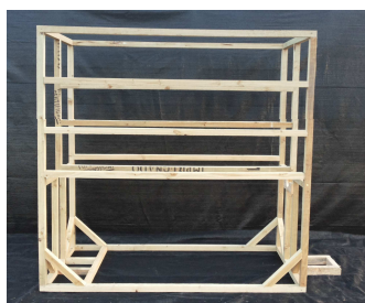
Armado de estructura de madera con tres niveles de producción
