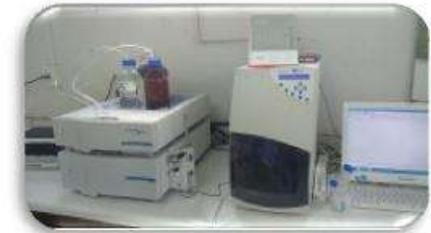
HPLC con detector light-scattering para cuantificar azúcares. Columna Kromasil 100-5NH2 de 4,6 x 250mm.
