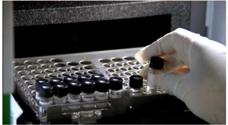
HPLC DE FASE REVERSA, CON DETECTOR UV/VIS PARA LA DETERMINACION DE POLIFENOLES TOTALES .
