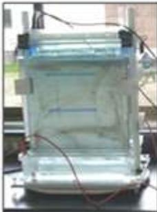
Separación de fragmentos mediante electroforesis vertical
