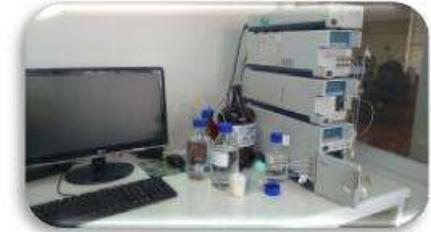
HPLC con detector UV visible para cuantificar ácidos orgánicos. Columna Waters C18 de 5µm 4,6 x 250mm.
