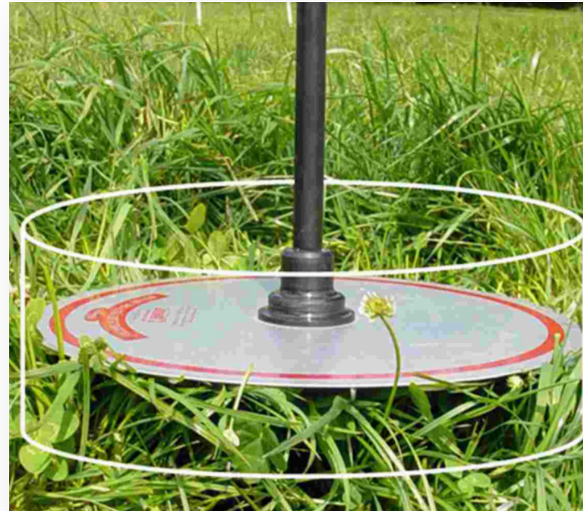
Fotografía 3.6. Pradera comprimida por el peso del plato.
