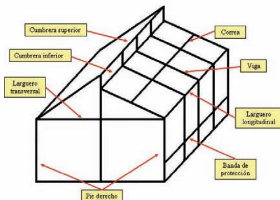
Figura 1. Estructura de un invernadero tipo capilla.
