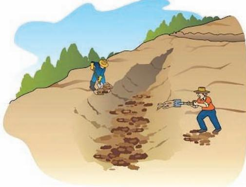
Figura 2. Procesos de eliminación del suelo de los bordes de la cárcava.
