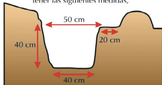
**Figura 2.** Construcción de zanjas.
