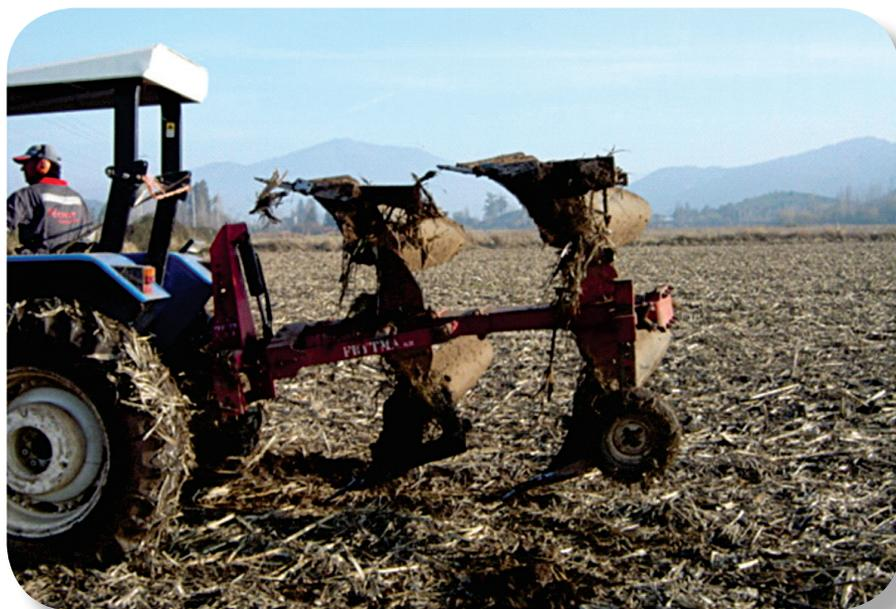
la incidencia de la vertedera se reduce al volteo y a la formación de tierra fina por fricción de los terrones con la superficie interna de dicha pieza.
