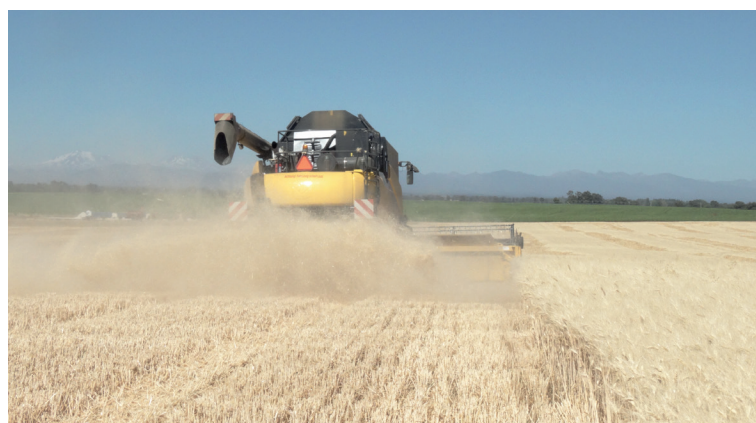
Foto 1. La opción más económica para manejar el rastrojo sin quema es picarlo y esparcirlo durante la cosecha, luego triturar la caña remanente y mezclarla con el suelo.
