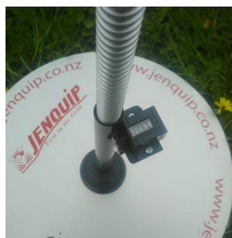
**Figura 3.** Plato de aluminio y registro de alturas comprimidas, que va acumulando las lecturas realizadas en cada punto.
