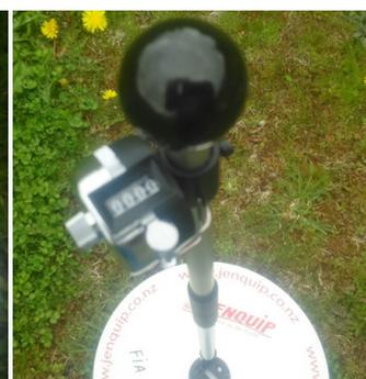
**Figura 4.** Registro contador de lecturas adosado al bastón o vástago. Permite contabilizar las lecturas.
