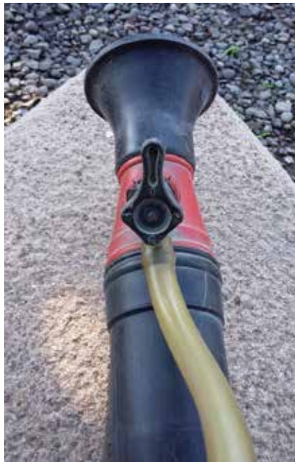
Figura 14.4. Manilla reguladora de paso de líquido desde el estanque hasta la tobera.
