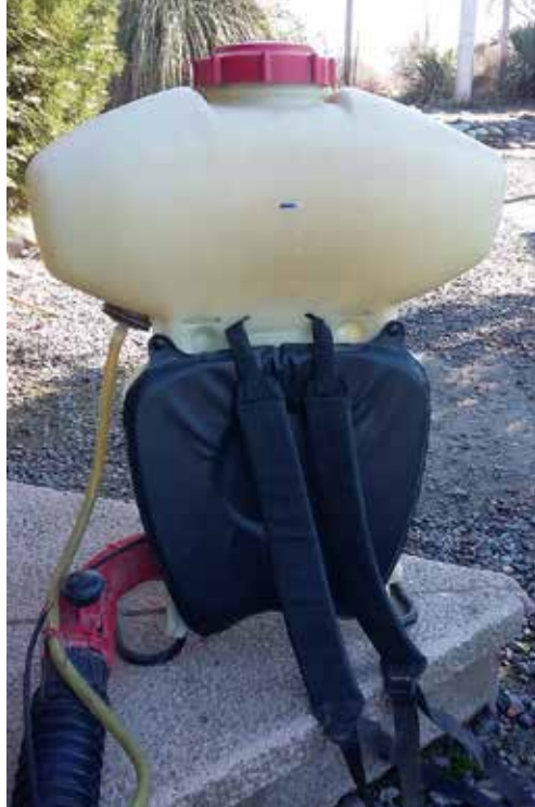
Figura 14.5. Marca del nivel de agua en el estanque del pulverizador, ubicado en un sitio nivelado.
