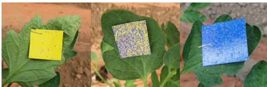
Figura 14.8. Uso de papeles hidrosensibles para comprobación de cubrimiento. Izquierda: pulverización deficiente. Centro: pulverización óptima. Derecha: pulverización excesiva.
