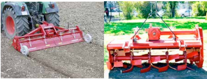
Figura 5.11. Rotovator y un detalle de su interior.
