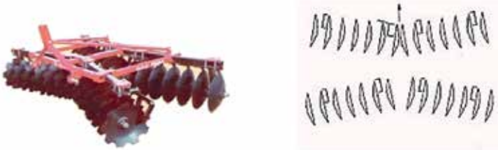
Figura 5.7. Rastra de doble acción o en tándem.
