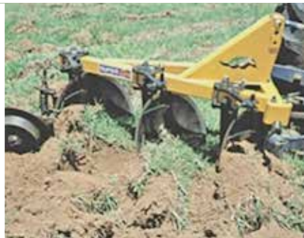
Figura 5.3b. Arado de discos trabajando.
