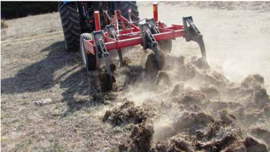
Figura 1.7. Arado subsolador-escarificador de 5 puntas, equipo adecuado para romper problemas de pie de arado en un terreno.
