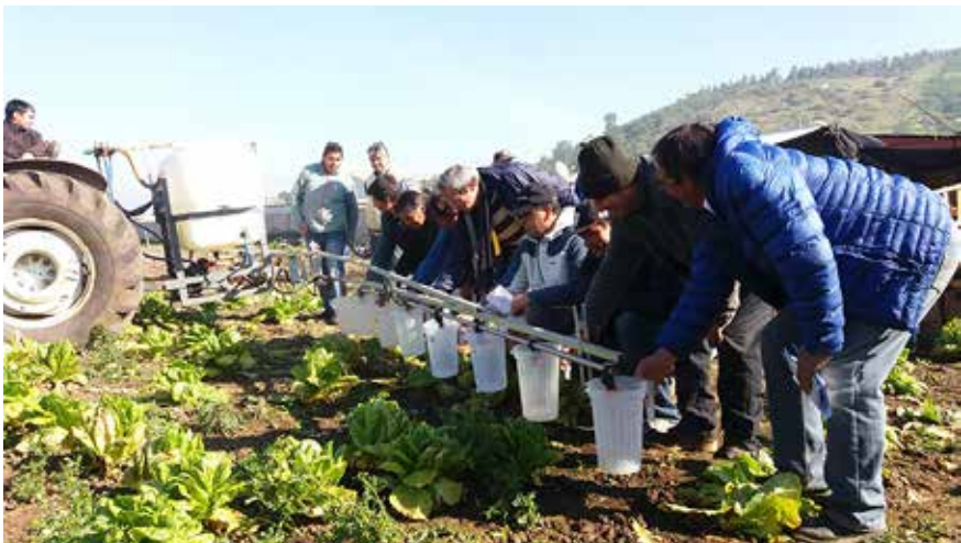
Figura 8.5. Medición real del caudal individual de las boquillas en un pulverizador hidráulico de barra.
