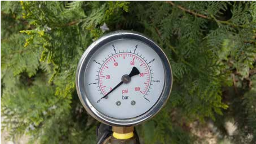
Figura 8.6. Manómetro adecuado para trabajar a presiones máximas de 3,5 a 4 bar.
